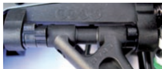
Nachlaufwinkelveränderungen an der Vorderachse sind mittels der C-Klipse an der Aufnahme des vorderen oberen Querlenkers ohne zusätzliche Teile schnell und problemlos möglich
