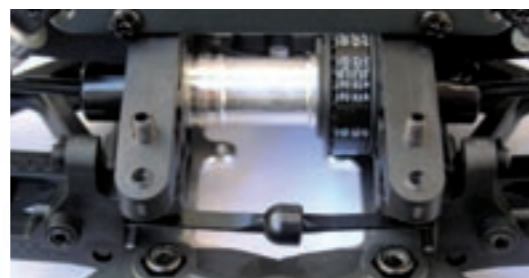
Von Werk aus ist der Messerstab an der Vorderachse flach, also eher weich eingestellt. Bei Bedarf kann er für härtere Wirkung um 90 Grad gedreht oder einfach ausgehängt werden
