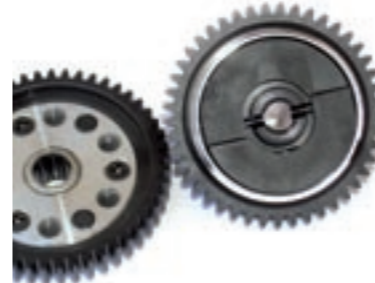
Im Inneren des Zweiganggetriebes taucht die übliche 2-Backenmechanik auf: Über deren zwei Verbindungsschrauben lassen sich die verborgenen Federn für ein späteres Schalten entweder stärker vorspannen oder für ein früheres Einkuppeln in den zweiten Gang herausdrehen/entlasten
