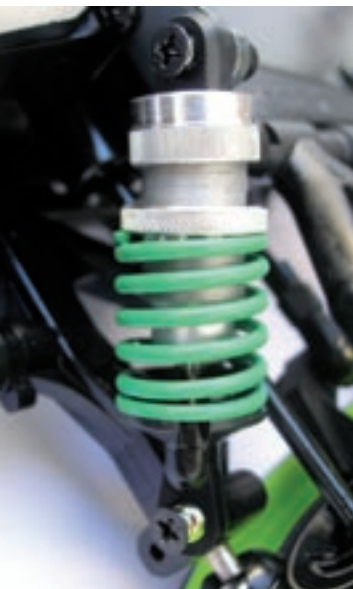
Ein absolutes Muss in diesen Geschwindigkeitsbereichen sind die Aluminiumölis. Über eine Rändelmutter auf dem Dämpfergehäuse lässt sich Federvorspannung einfach anpassen
